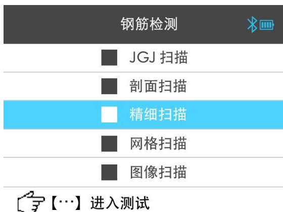
图 4.3 钢筋检测界面
