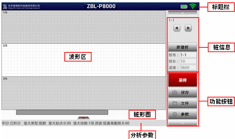
图 3.1 反射波测桩软件主界面
